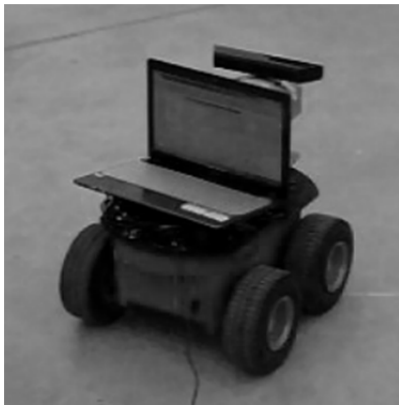
Fig.6. Robot pioneer 3-AT® con Pc y sensor Kinect® incorporados.
