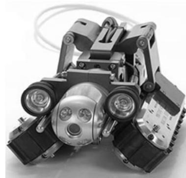
Fig.2. Versatrax 150TM. Tomado de [10]
