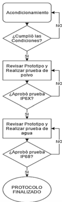
Fig.3. Diagrama de Flujo para prueba de Protocolo IP68
