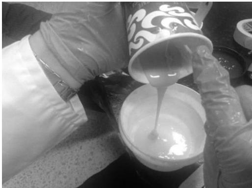
**Fig. 1.** Preparación del material para elaborar el modelo físico de la piel.
