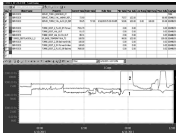
Fig.14. Control de flujo de la torre de destilación
