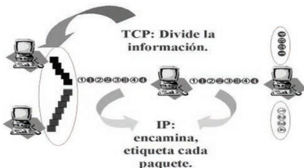
Fig. 3. Funcionamiento protocolo TCP/IP
