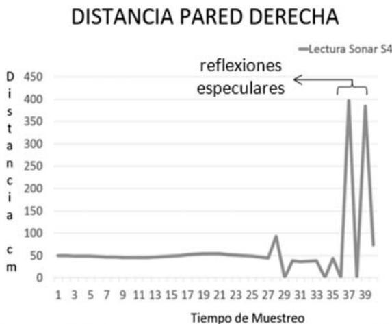
Figura 15. Datos proporcionados por el sonar S4
