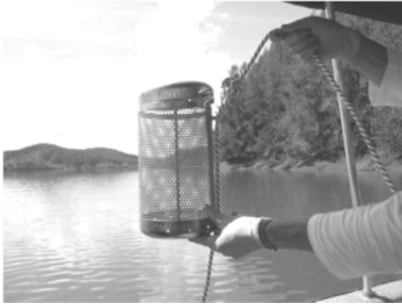
Fig 2. Montaje de muestreadores pasivos en el cuerpo de agua.
