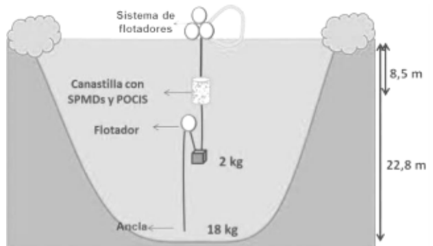
Fig 5. Montaje de muestreadores pasivos dentro de la columna de agua de un embalse.
