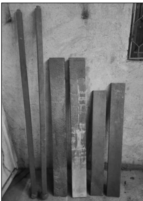
Figura 8. Estibas y postes de plástico ABS desarrollados
