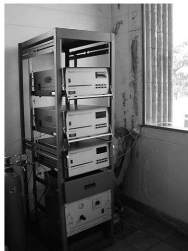
Figura 3: Equipo Automático de Medición de Monóxido de Carbono. Zona Guayabal
