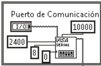
Fig. 13. Configuración del puerto serial, bloque VISA. [4]
