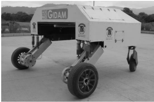
Fig.1. Imagen de CERES: Vehículo de tracción diferencial eléctrico (48V), con capacidad de carga de 100 Kg de abono sólido, 20 litros para fumigación y un sistema de remoción de maleza.
