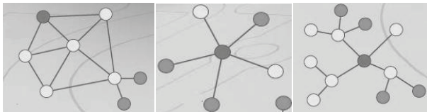
Figura 3. Topologías de malla (izquierda), estrella (centro) y clúster de estrella (derecha).
