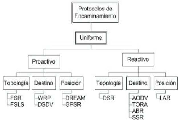
Figura 5. Protocolos de encaminamiento Uniforme
